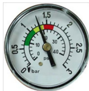
1,3 \text{ kg/cm}^2 : La pression est 0,5 \text{ kg/cm}^2 supérieure à la pression initiale, cela signifie qu'il faut procéder au LAVAGE
